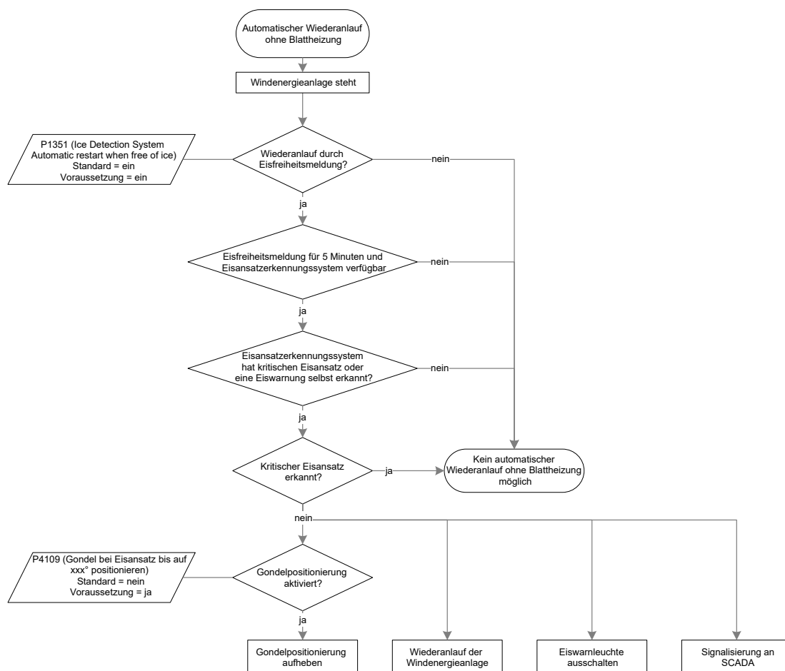
Abb. 8: Automatischer Wiederanlauf ohne Blattheizung
