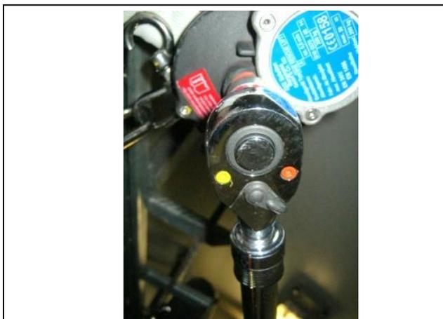
3. Rettungsgerät und Knarre auf „rot“ stellen und zum Podest steigen. Das Rettungsgerät an der Brusttöse befestigen.
