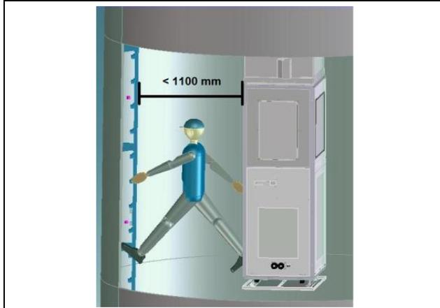
1. Bei weniger als 1100mm Abstand zwischen Betonurm und Aufstiegshilfe ist ein Übersteigen möglich.
