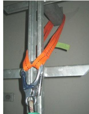
2. Lange Bandschlinge an einem geeigneten Anschlagpunkt befestigen und den Karabiner des Rettungsseils einhängen.
