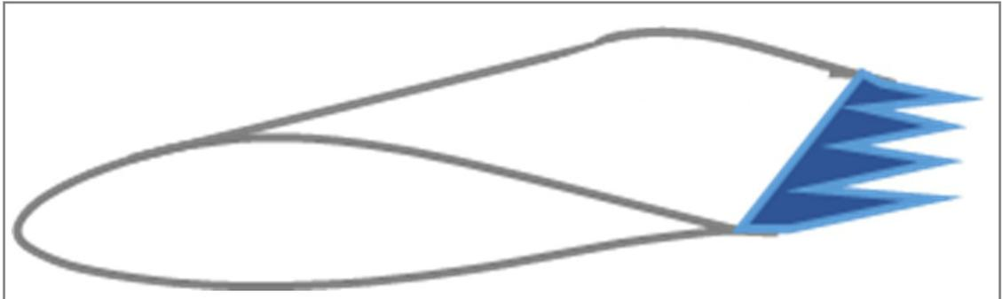
Abb. 2: *Prinzipskizze Serrations*
